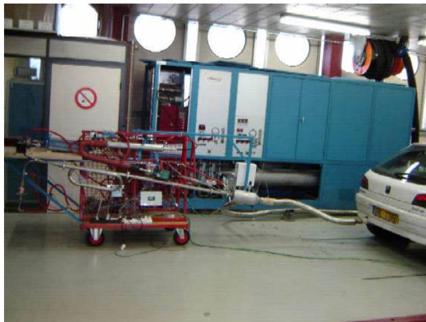
Figure 9 : Vue d'ensemble du système de prélèvement
