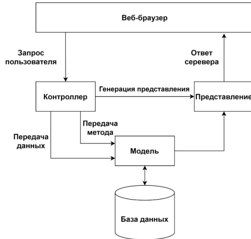
Рис. 1. Схема работы веб-приложения, разработанного согласно паттерну MVC
