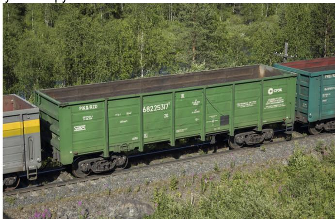
Рис. 2. Внешний вид полувагона глухонного модели 12-5190
