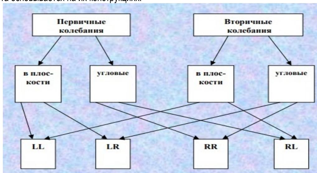
Рис. 1. Классификация микромеханических гироскопов
