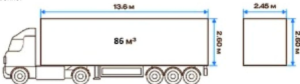
Рис. 1. Тентованный полуприцеп 86 куб. м. (EURO) MAN
