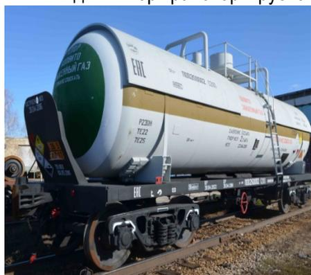
а) Цистерна для перевозки хлора, модель 15-1556-03
