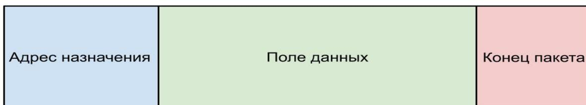
Рис. 4. Формат пакета SpaceWire
