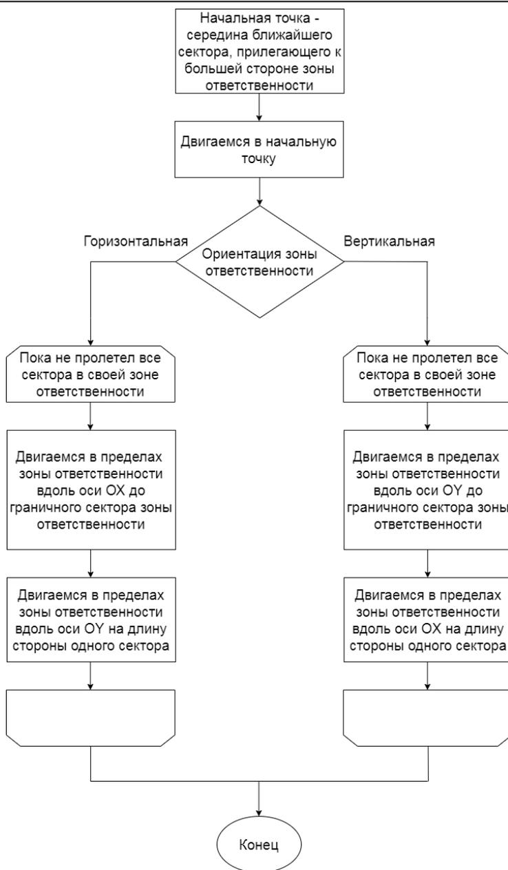
Рис. 8. Блок-схема алгоритма построения маршрута в прямоугольной зоне ответственности
