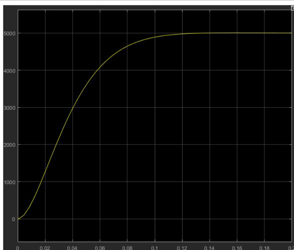
Рис. 6. ПП канала скорости вращения бесколлекторного двигателя
