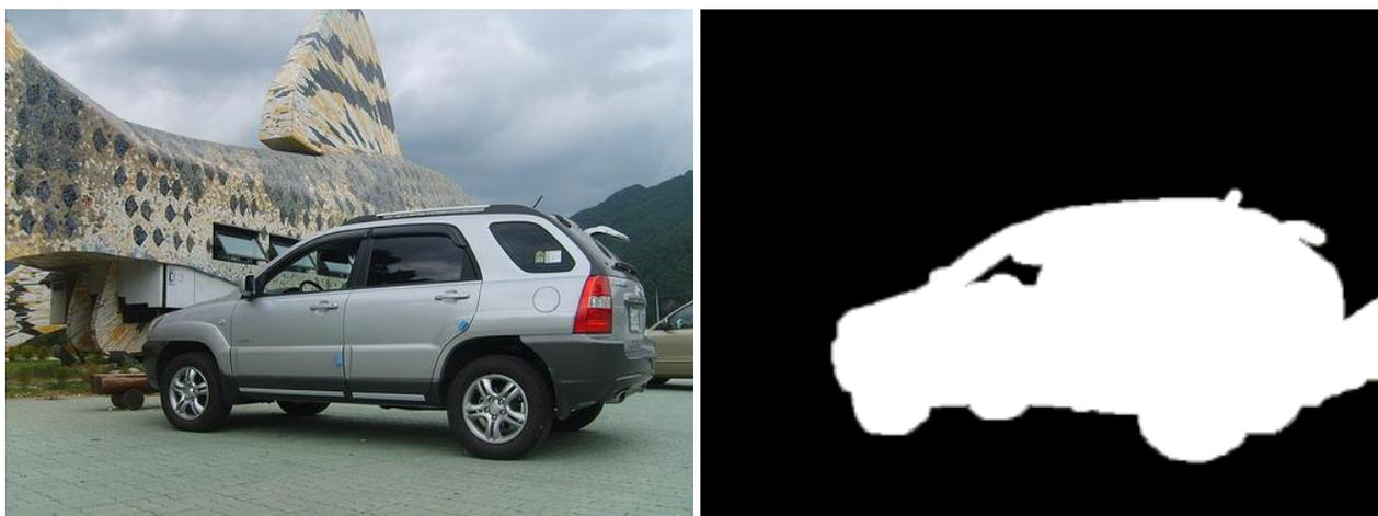
Рис. 1. Оригинальное изображение (слева) и его семантическая сегментация (справа)
