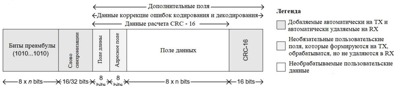
Рис. 2. Формат пакета CC110F<sub>x</sub> / CC1111F<sub>x</sub> SWRS033H
