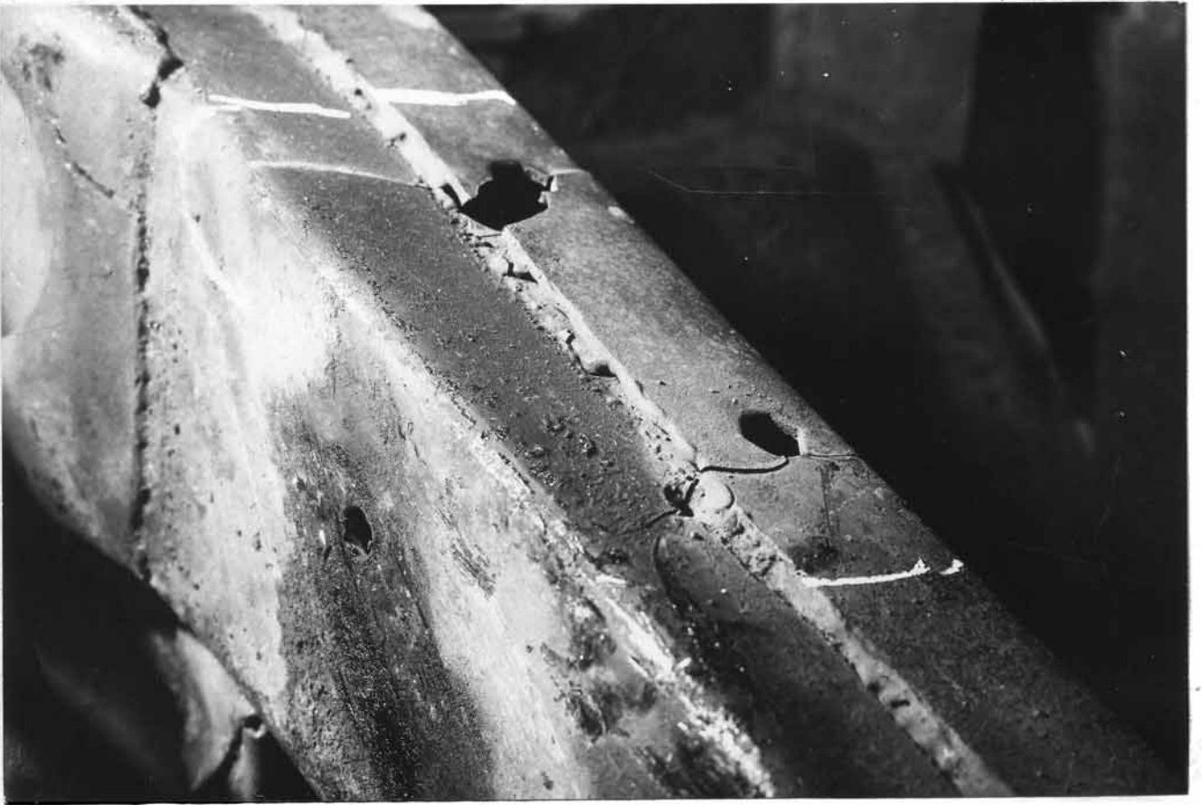
фото № 12. Трещины левого лонжерона рамы в месте крепления руля.
