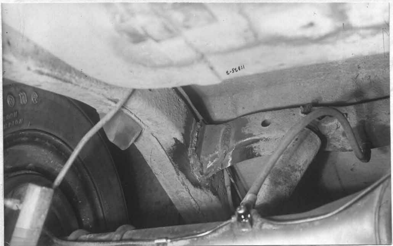
фото № 6. Трещины по сварке в местах соединения 4-й поперечины с лонжеронами рамы /после постановки усилителей и ремонта сваркой/.
