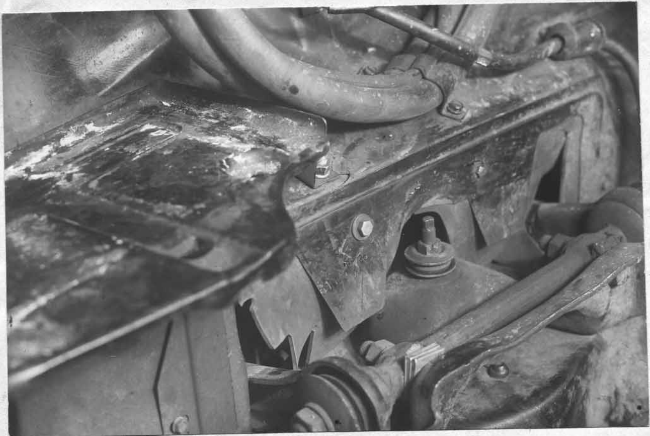
фото № 5. Трещины брызговика переднего правого крыла под полкой аккумулятора.
