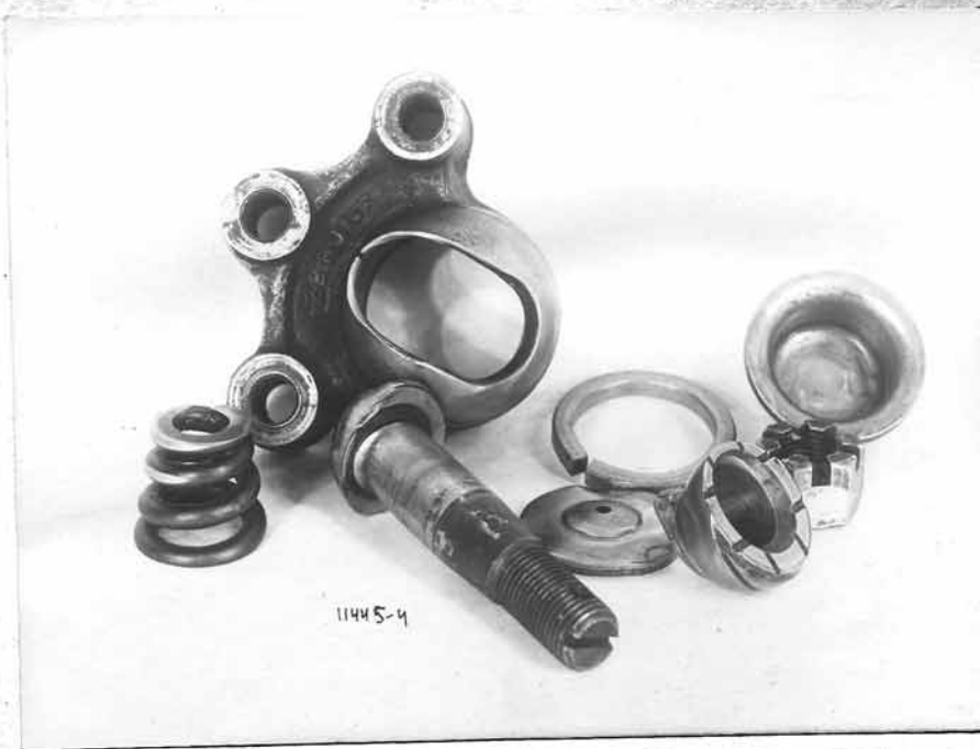
фото № 14. Значительный износ деталей обеих верхних шарниров безшкворневой передней подвески.
