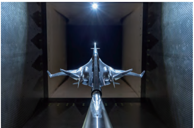
低ソニックブーム設計機体模型の2m×2m超音速風洞試験
