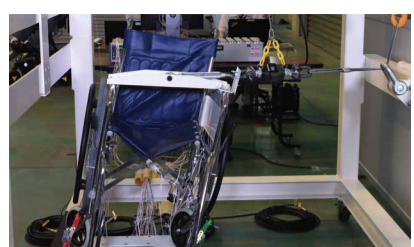
折り畳み式車椅子を使用した静強度試験(縦横など各方向に規定の荷重をかけて行う強度試験)の様子
