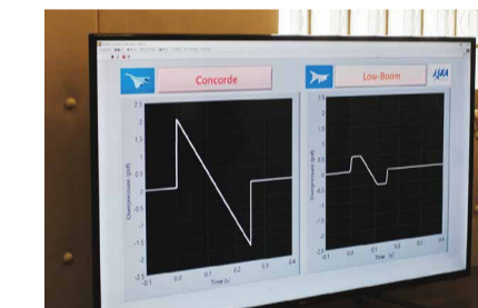
超音速旅客機「コンコルド」のソニックブーム(左)と、JAXAが研究中の機体が発するソニックブーム(右)を可視化したグラフ。グラフが小さく、先端が尖っていないことから、音が小さく、柔らかくなっていることが分かる。
