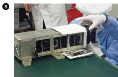
「TUMnanoSAT」の衛星搭載作業の様子(撮影日:2022年3月4日)
