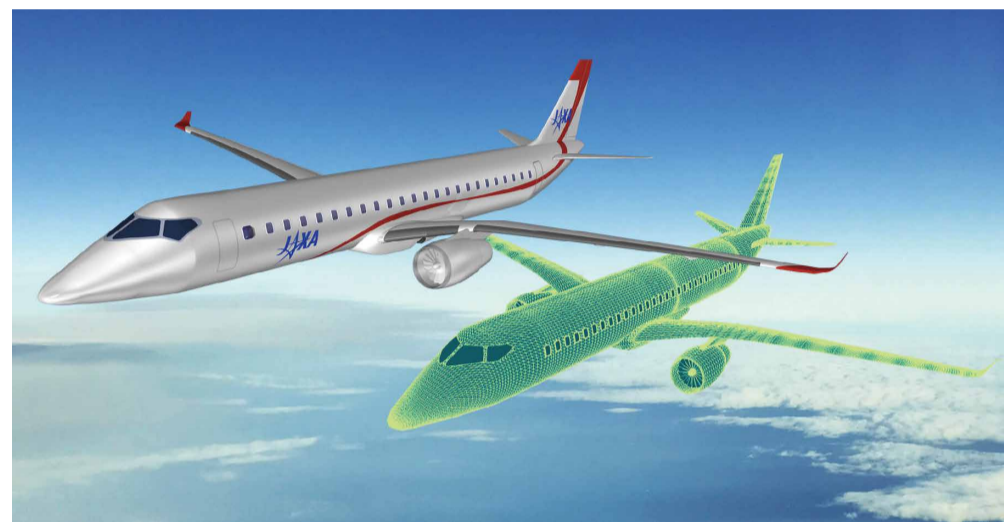
実機と同じモデルをデジタル空間に再現しさまざまな分析などを行う、デジタルツインと呼ばれる技術のイメージ
