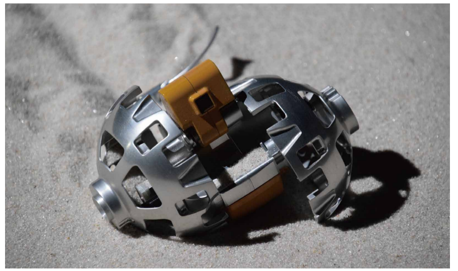
上:LEV-2の変形の仕方 下:左右に揺られて進む「クロール走行」時のLEV-2
