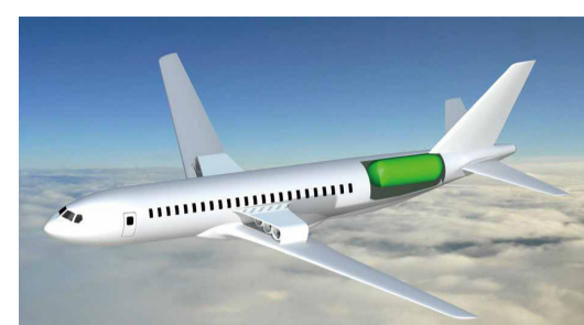
液体水素が入った燃料タンク(緑色の部分)を搭載した水素航空機のイメージ
