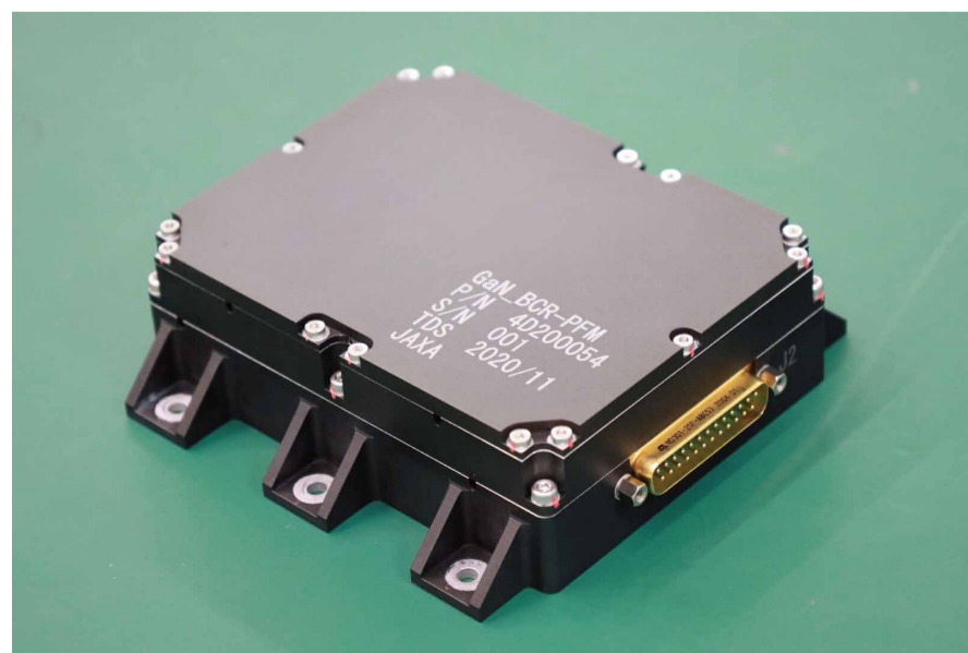
開発したバッテリー充電器GaN_BCR(サイズ:125x133x40mm)
