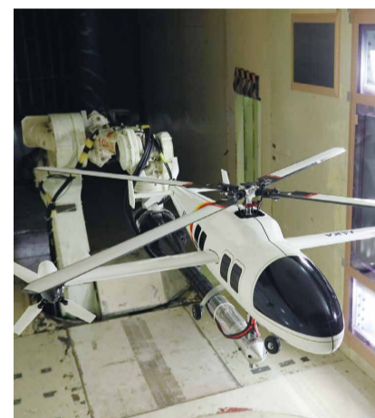
左:高速ヘリコプターのイメージCG。 右:実験中の高速ヘリコプターの概念模型機。
