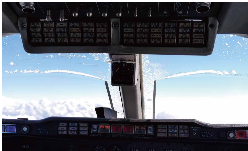
氷結層の観測時に航空機のウインドスクリーンに付着した氷。
