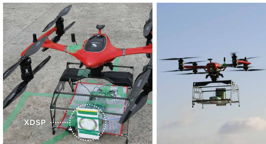
XDSPとドローンを組み合わせた通信実験も行っている。
