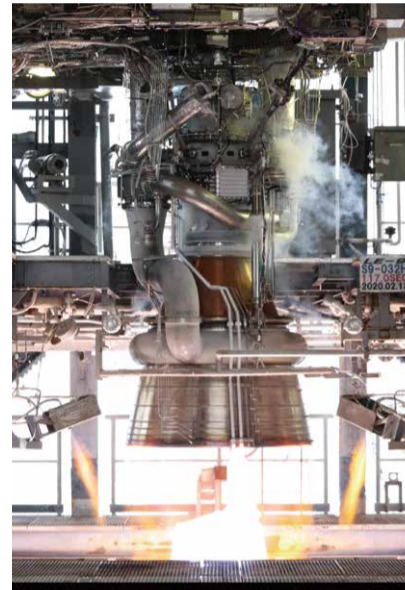
LE-9認定型#1エンジン 第1回自然燃焼試験の様子。
