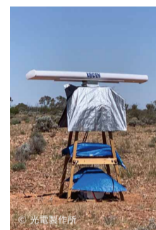
上部のアンテナを回転させながら電波を出し、距離と方位の測定を行う。
