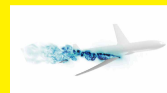
数値流体力学(CFD)で解析した、航空機周りの空気の流れを可視化したもの。
