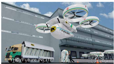
物流eVTOLの下に付いている大型貨物ユニット(PUPA®8801)は外すことができ、そのままトラックに積み込める。
