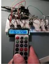
Capteur temperature choix du type de degres par infrarouge using arduino ENGLISH VERSION [HERE](#) Dans ce programme nous allons voir comment capter une température et afficher sa valeur sur un lecteur LCD en choisissant si on veut l'afficher en°C ou °F grâce à une télécommande infrarouge. Dans ce tuto j'utilise: - Une carte SainSmart (similaire à Arduino..... Listed under: LCD Projects
