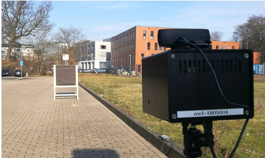
Abbildung 7.42: Messaufbau zur Verifikation der Hintergrundlichtunterdrückung
