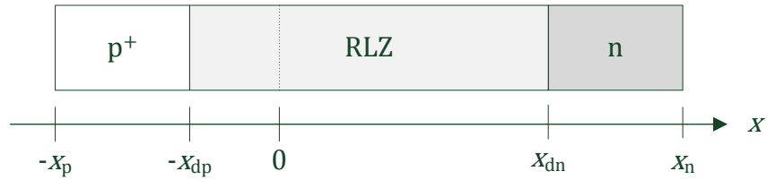
Abbildung 2.8: pn-Übergang bei negativer Vorspannung nach [27]
