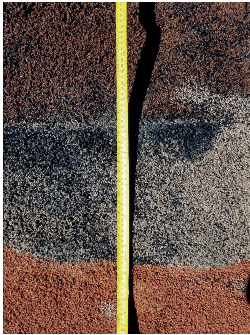
Photo 5 : Vue de dessus des substances réactives granulaires structurées dans une BPR. Dans cet exemple, la zéolite (orange), le charbon actif granulaire (noir) et la zéolite enrichie en nutriments (blanc). L'eau s'écoule du bas de l'image vers le haut.
