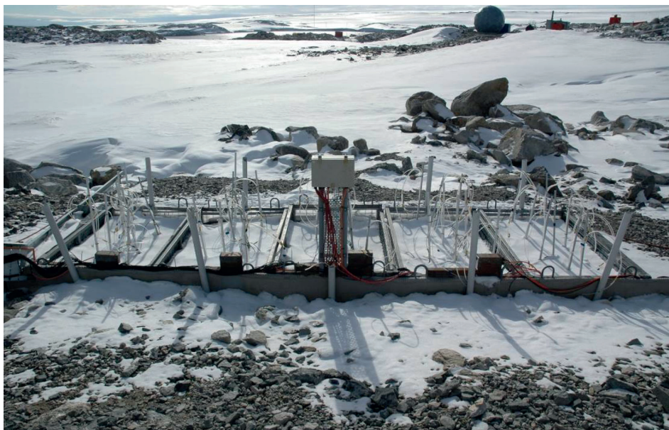
Photo 7 : Porte équipée de nombreux instruments à des fins de recherche et d'essai de différentes substances granulaires.
