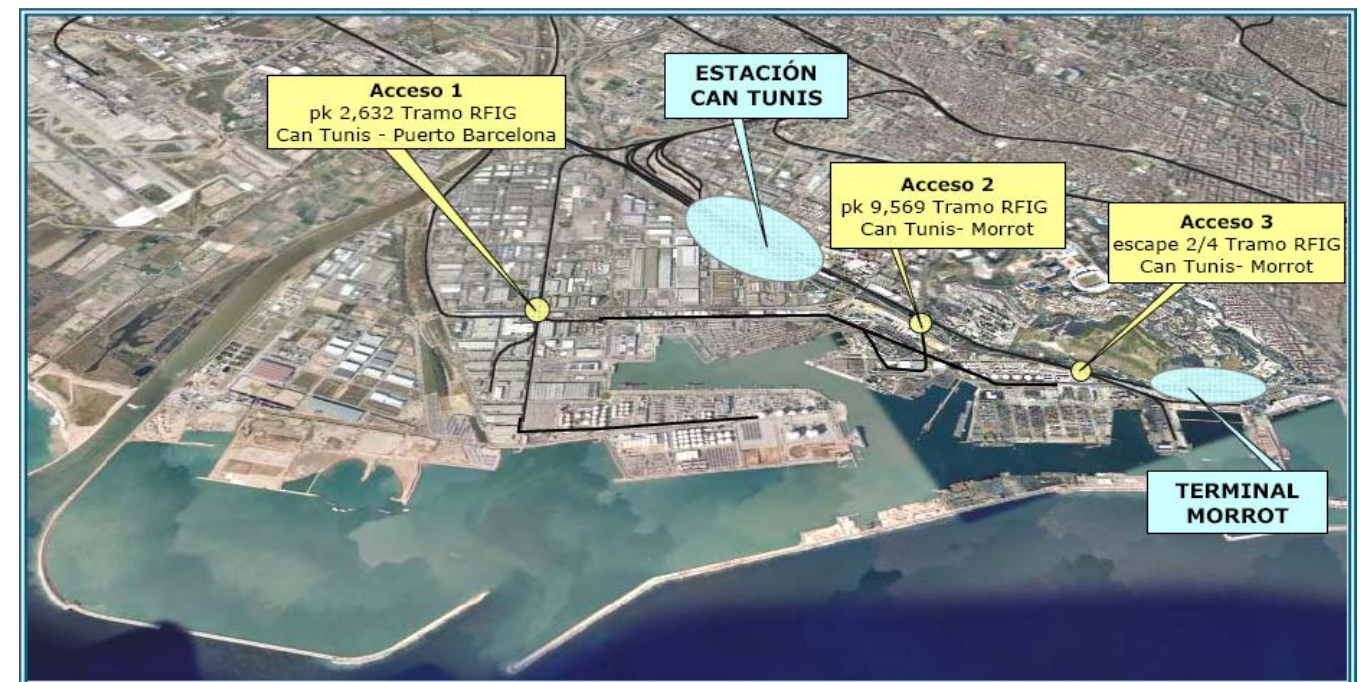
Figura 21 Accessos ferroviaris al Port de Barcelona
