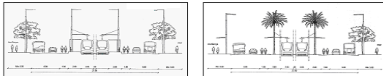
Plataforma central, a mode de mitjana ajardinada, entre els carrils de circulació
