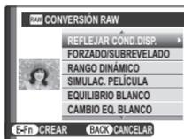
**2** Pulse el selector hacia arriba o hacia abajo para resaltar un ajuste y, a continuación, pulse el selector hacia la derecha para seleccionarlo. Pulse el selector hacia arriba o hacia abajo para resaltar la opción deseada y, a continuación, pulse **MENU/OK** para seleccionarla y volver a la lista de ajustes. Repita esta paso para ajustar otros parámetros.
