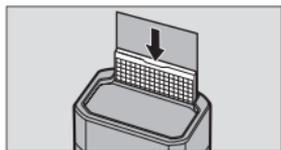
为获得最佳效果，请靠近您的拍摄对象并将闪光灯头向上旋转  $90^\circ$ ，水平旋转  $0^\circ$ 。若闪光灯头已向左或向右旋转，则可能无法获得预期效果。
