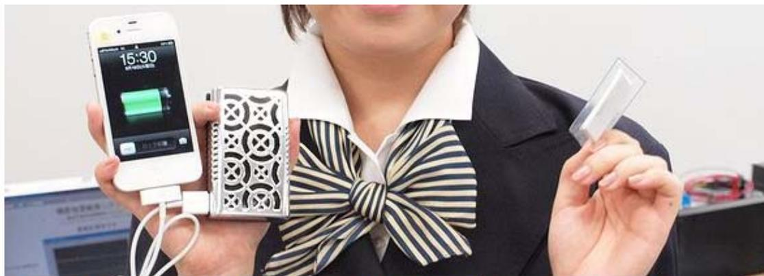
図1 開発した携帯型機器向けの小型燃料電池「mobile Aqua」(仮称) 燃料電池セルや電子回路を内蔵する本体(女性の右手にある銀色の箱)と、使い捨てのカートリッジからなる。カートリッジの内部には、水素発生シート(女性の左手、38×38×2mm)と水が内蔵されており、シート1枚で水素を4.5リットル取り出すことができる。取り出せる電力量は5Whだ。
