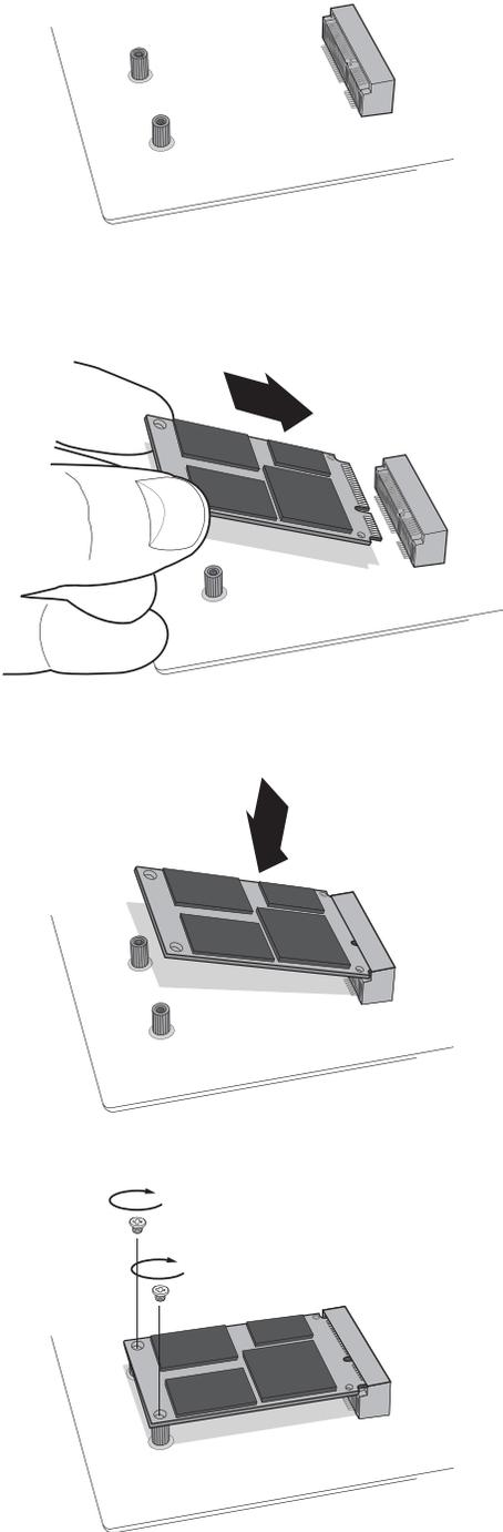
Abbildung 2: Installation mit Clips
