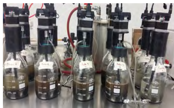
Figura 3.6. Equipo AMPTS II en la evaluación de la producción de metano derivado de las aguas residuales del beneficiado húmedo del café.
