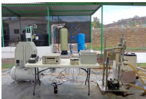
Figura 3.10. Sistema de ozonación a nivel piloto para la validación tecnológica en pruebas de remoción del color de vinazas tequileras.
