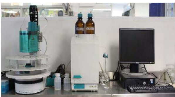
Cromatógrafo de iones. Equipo analítico para la determinación de especies de aniones y cationes en muestras líquidas.
