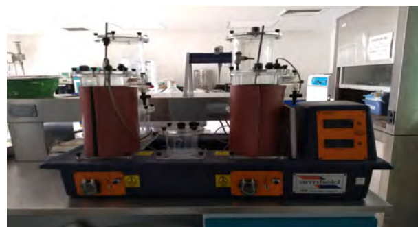
Reactor o Digestor Anerobio. Equipo usado para llevar a cabo pruebas de tratabilidad de las aguas residuales.
