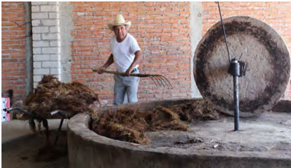
Figura 6.2. Molienda artesanal de piñas cocidas de agave en tahona para la extracción de jugos del bagazo. Fuente: https://www.google.com.mx/search?
