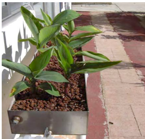
Figura 3.5. Humedal artificial subsuperficial a escala laboratorio para las pruebas de tratabilidad del agua residual del beneficiado húmedo del café.
