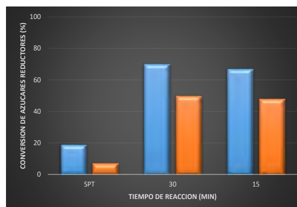
Figura 4.11. Conversión de azúcares reductores después del pre-tratamiento de bagazo de caña de azúcar con ozono. SPT- Sin pre-tratamiento.
