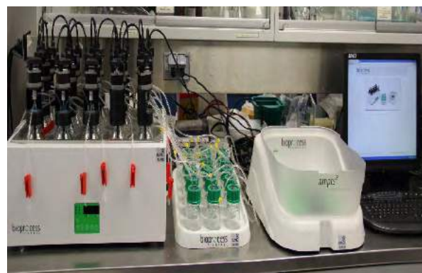
Sistema automático de potencial de metano. Equipo que permite medir la generación de metano bajo condiciones controladas.
