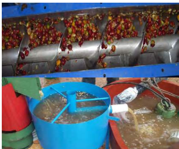
Figura 3.4. El proceso de beneficiado húmedo incluye las etapas de recibo, lavado, despulpado, fermentación, remoción del mucílago, lavado, clasificado y secado del café al 12% de humedad.
