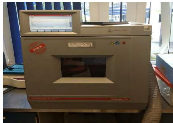
Reactor o Digestor Anerobio. Equipo usado para llevar a cabo pruebas de tratabilidad de las aguas residuales.
