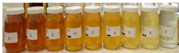
Figura 3.11. Ejemplo cualitativo de la disminución del color tras las pruebas de tratabilidad con ozono a nivel piloto.
