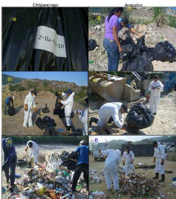
Figura 4.4 Municipio de Chilpancingo: a) bolsa de residuos sólidos urbanos etiquetada por zona de la ciudad; b) Pesada por grupo de bolsas muestreadas por estrato socioeconómico; c) Separación para la cuantificación de los residuos sólidos generados durante 8 días. Municipio de Acapulco: d) Separación por estrato socioeconómico de las bolsas recolectadas, e) Determinación del peso de las bolsas para obtener la generación per cápita , f) Separación y cuantificación de las fracciones de los residuos sólidos urbanos.
