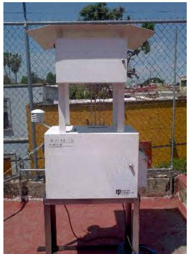
Figura 6.3. Equipo partisol modelo 2300 ubicado en la estación Tlaquepaque, el cual permitió la colecta de partículas \text{PM}_{2.5} y \text{PM}_{10} para la determinación de compuestos orgánicos como los HAPs y quinonas. Espuma de poliuretano fueron empleadas para el muestreo de dichos compuestos, pero en la fase gas.
