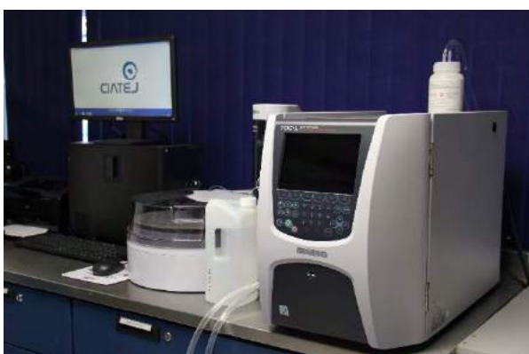
Analizador TOC-L. Equipo para determinar el contenido de materia orgánica medida como carbón orgánico total, en muestras líquidas.
