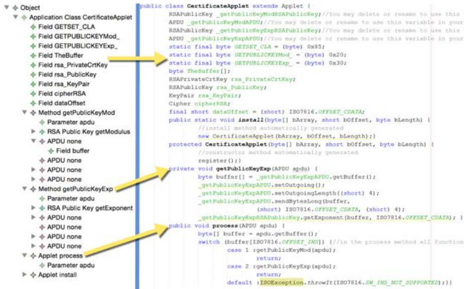
Şekil-8. CertificateApplet uygulamasına ait DSL4JavaCard modeli ve bu modelden otomatik üretilen Java Card kodları
