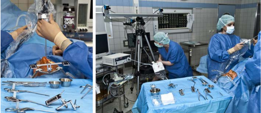
Abbildung 1: Messaufbau. Links: Selbstentwickelte planare Marker des optischen Navigationssystems. Rechts: OP-Aufbau mit Kamerasystem und planaren Markergeometrien an unterschiedlichen chirurgischen Instrumenten.
