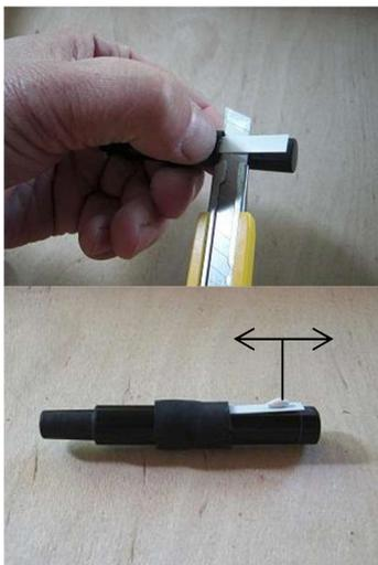
リードがすぐに閉じて音が止まる場合には、リードの舌（振動する部分）の根元の部分を親指で押さえ、舌とボディの間にカッターの刃を差し込んで、上向きにごく軽く力を加えてやります。これにより、舌の開き具合が大きくなり、リードが閉じにくくなります。但し、同時に音がやや低くなるので、スライドを使ってピッチを調整します。但し、あまり開き具合を強すぎると舌が折れ曲がりすぎたり破損したりするので、注意しましょう。
