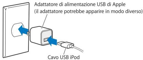
**ATTENZIONE:** assicurati che l'alimentatore di corrente sia completamente assemblato prima di collegarlo a una presa elettrica.
