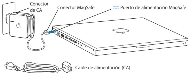
Para ampliar el alcance de su adaptador de corriente, tire del conector de CA para separarlo del adaptador. Conecte el cable de alimentación incluido con el ordenador al adaptador y asegúrese de que está firmemente encajado. Enchufe el otro extremo en la toma de corriente. El cable de alimentación incluye una conexión de toma a tierra.
