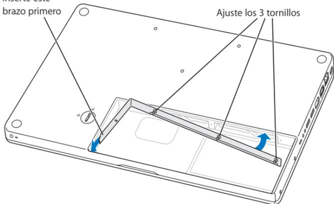
**Paso 3: Coloque de nuevo la batería.**
