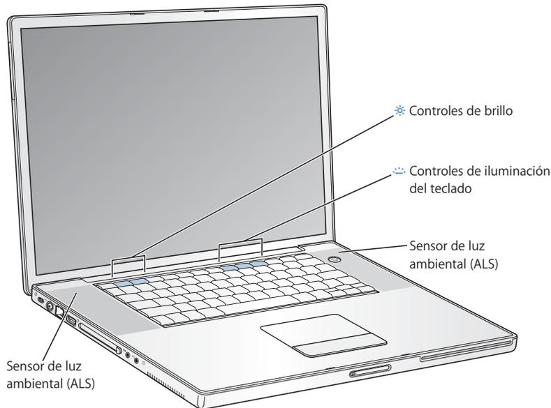
El ordenador incorpora iluminación en el teclado y un sistema de sensores de luz ambiental (ALS). Los sensores ALS, que están situados bajo las rejillas de los altavoces, ajustan automáticamente el brillo de la pantalla y la iluminación del teclado de acuerdo con la luz disponible en el entorno. No obstante, también puede ajustar la iluminación del teclado manualmente mediante las teclas F8, F9 y F10.
