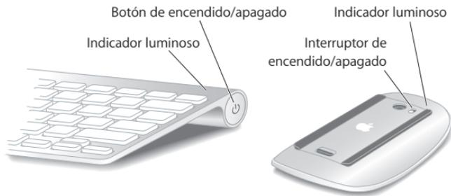
Cuando encienda el teclado y el ratón por primera vez, el indicador luminoso brillará durante 5 segundos para indicar que las pilas están en buen estado. A continuación, el indicador luminoso parpadeará hasta que encienda el iMac y se establezca la conexión. Si el teclado o el ratón no se encienden, compruebe que las pilas están instaladas correctamente y cargadas (consulte la página 47).
