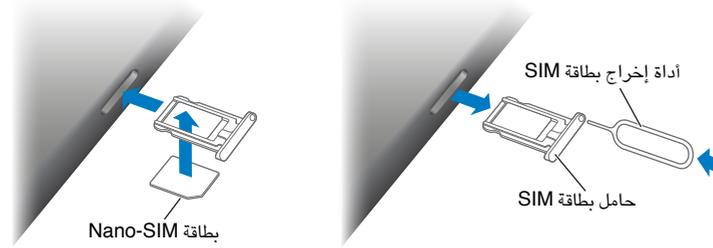
فتح حامل بطاقة SIM: أدخل أداة إخراج بطاقة SIM (تُباع منفصلة) في الفتحة الموجودة بحامل بطاقة SIM، ثم اضغط بقوة وادفع الأداة بشكل مستقيم حتى يبرز حامل البطاقة للخارج. اسحب حامل بطاقة SIM للخارج لتركيب بطاقة SIM أو استبدالها. إذا لم يكن لديك أداة إخراج بطاقة SIM، فحاول باستخدام طرف مشبك ورق لإخراجها.
