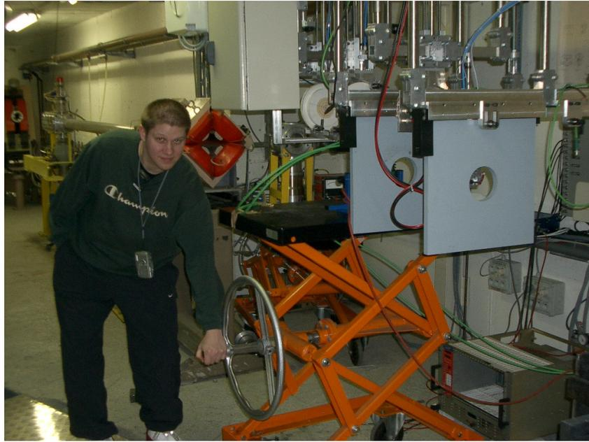
*Photo 1 : Zone cible montrant le banc d'irradiation*
