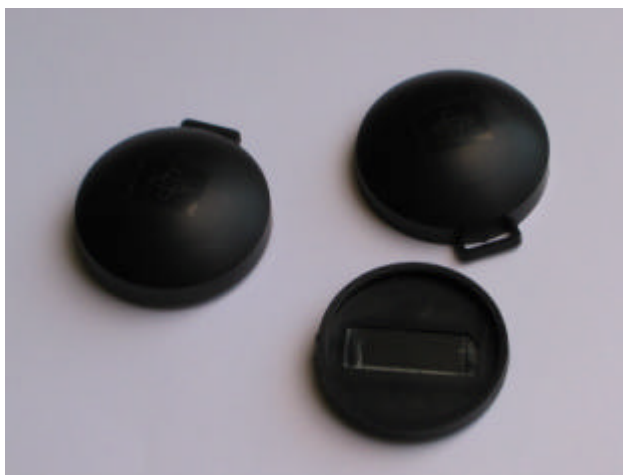
Figur 3.1. Spårfilm i dosa. På bilden finns en komplett dosa till vänster och en öppnad till höger. På insidan av dosans botten (nedtill) syns själva spårfilmen. Dosan är 58 mm i diameter och ca 20 mm tjock.
