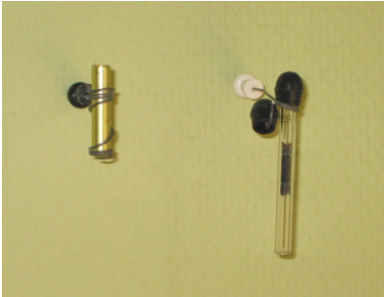
Figur 3.5. Utrustning för mätning av luftväxling enligt AIM-metoden. Sändaren, till vänster på bilden, är 31 mm lång.
