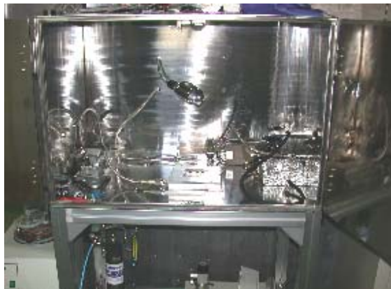
그림 3-3-11. Test shielding box 및 진공펌프
