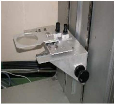
그림 3-3-18. 완성된 피검물 이송장치 사진
