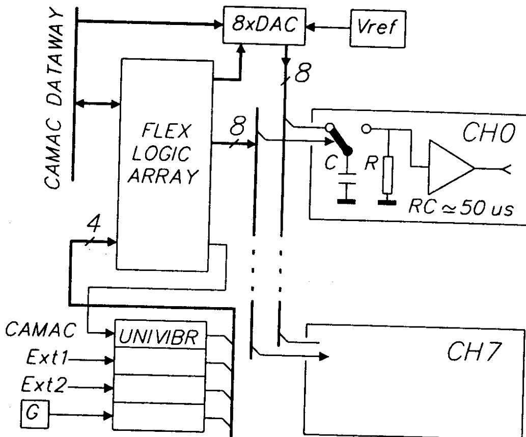
Рис.1. Структурная схема генератора
