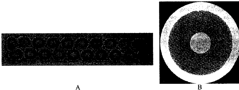
Figure 4 : section d'un câble de type Rutherford (A) et coupe d'un brin NbTi (B) Cross section of a Rutherford cable (A) and cross section of a NbTi wire (B)
