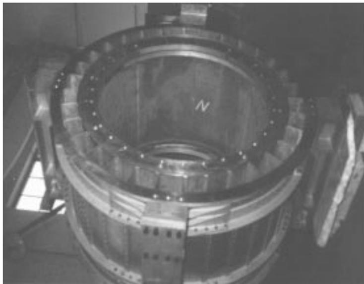
**Figura 1.8:** Il magnete, racchiuso dalla struttura cilindrica in alluminio su cui sono fissati gli altri componenti di AMS.
