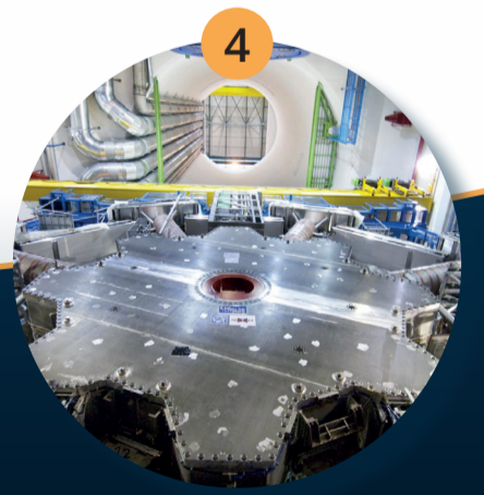
Mıknatıs Sistemi momentum ölçülebilmesi için her bir yüklü parçacığın hareket yönünü saptırır.
