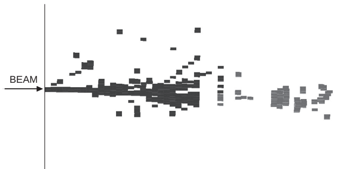
FIGURE 3.12 – Événement d'une gerbe hadronique enregistré dans le prototype du SDHCAL comportant des "trous" dans certains plans. Cet effet est corrigé lors de la reconstruction des événements physiques en agrandissant la fenêtre de temps d'un bin en temps supplémentaire.
