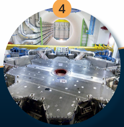
Систем магнета закривљује трајекторију сваке наелектрисане честице да би се омогућило мерење њеног импулса
