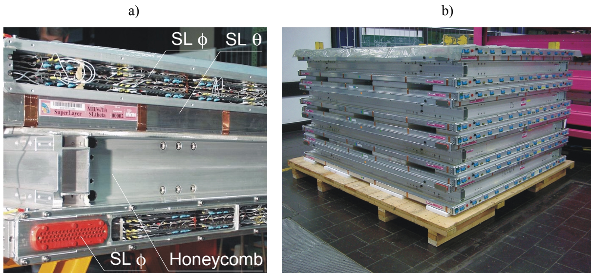
Abbildung 2.6: (a) – Eine komplette, mit Elektronik bestückte Aachener Myonkammer [10]. Sie besteht aus zwei \phi -, einer \theta -Superlage und dem Abstandshalter. Die obere \phi -Superlage ist noch nicht mit dem HV-Deckel verschlossen, an der unteren ist für Testzwecke ein HV-Deckel aus Plexiglas angebracht. (b) – Vier fertige und getestete Myonkammern bereit für den Transport zum CERN [11].
