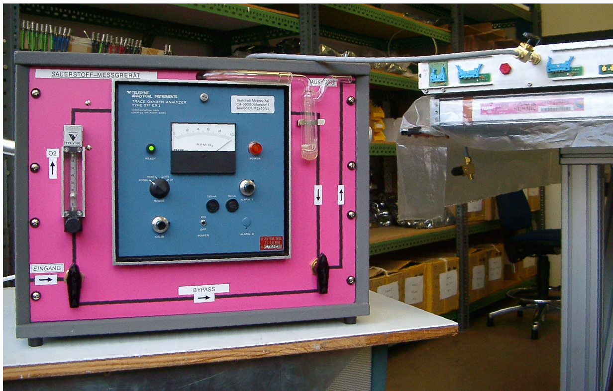
Abbildung 6.2: Mit Hilfe eines Sauerstoffspurenanalysators wird am Auslass einer Superlage eine Sauerstoffgehaltsmessung vorgenommen [11]. Während des Spülens der Kammer wird das Gas um das Messgerät geleitet, um die Sonde zu schonen. Die Myonkammern liefern nur dann korrekte Ergebnisse, wenn die O_2 -Konzentration den Wert 550 ppm nicht überschreitet.
