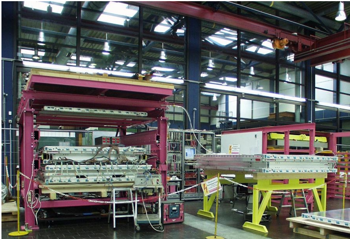
Abbildung 2.10: Der Aachener Teststand [10]. Um die Qualität und Funktion der gebauten Myonkammern zu überprüfen, werden diese verschiedenen Tests unterzogen. Im Bild sieht man eine Kammer, an der ein Hochspannungsfestigkeitstest vorgenommen wird (rechts auf dem gelben Gestell) sowie eine Kammer und ein paar einzelne Superlagen, deren Funktionen durch Auslese und Auswertung der kosmischen Myonen bewerkstelligt wird (links in der rosafarbenen, speziell dafür konstruierten Testvorrichtung).
