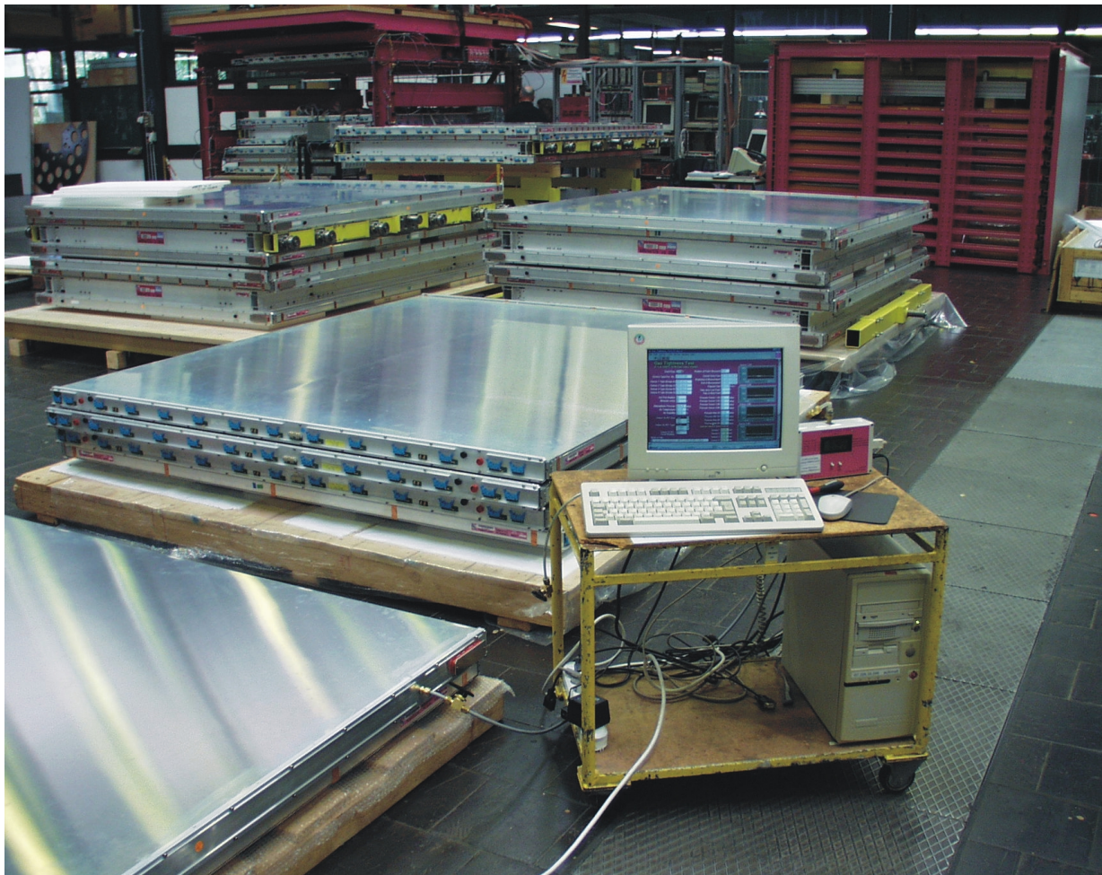
Abbildung 4.3: Gasdichtigkeitsmessung an einer einzelnen Superlage. Die Messung erfolgt mit Hilfe des Manometers PG4 , das über eine serielle Schnittstelle mit einem Rechner verbunden ist. Der zeitliche Druckabfall wird von einem Programm registriert. Anhand dieser Messdaten kann die Zeitkonstante, die ein Maß für die Dichtigkeit darstellt, berechnet werden.
