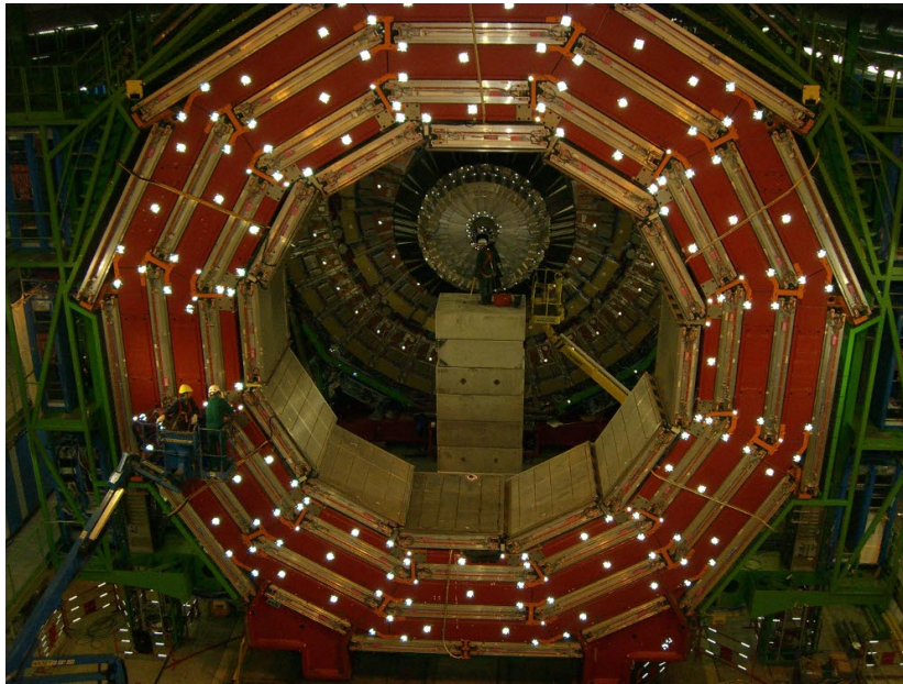
Abbildung 4.3: Das Myonsystem des CMS in der Caverne. Quelle: CMS
