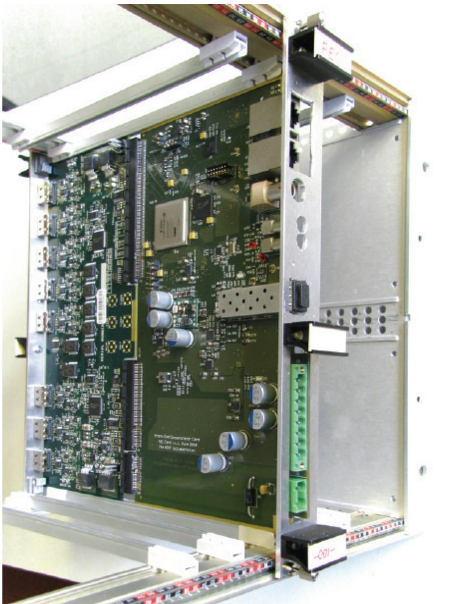
**Figura 1-4. Tarjeta FEC conectada a una tarjeta de expansión (tarjeta ADCs) montada en un rack de 19" 6U**
