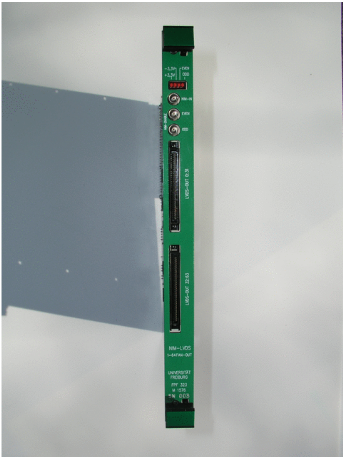
Abbildung B.11: Die Abbildung zeigt das NIM-LVDS 1-64 Verteilermodul für den VME Einschub von vorne. Zu erkennen sind die Buchsen für die Eingangssignale (NIM-IN, EVEN-, ODD-NIM-ENABLE) sowie die Stecker für die 64 Ausgangssignale (LVDS-OUT 0:31 und LVDS-OUT 32:63).
