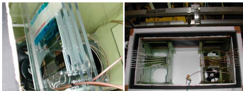
Figure 3-13: Les supports d'irradiation empilés (à gauche) et la boîte froide d'irradiation (à droite).
