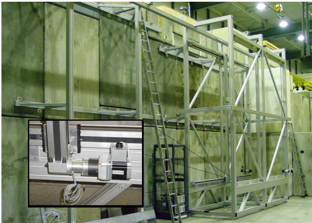
Abbildung 2.7: Photographie des Röntgenteststandes kurz vor der Fertigstellung. Die eigentliche Messung findet innerhalb der kastenförmigen Struktur in der rechten Bildhälfte statt. Die Doppelebenen werden hängend an dem oberen Aluminiumbalken befestigt, der den Kasten nach links verlässt, wobei sie entlang dieses Balkens verschiebbar sind. Der Teil des Aufbaus, in dem die eigentliche Messung stattfindet, ist aus Stabilitätsgründen oben geschlossen, weswegen die Doppelebenen mit Hilfe eines Krans nur dann gewechselt werden können, wenn sie nach links aus dem Kasten herausgefahren sind. Vergrößert dargestellt ist einer der 4 Schrittmotoren, die die beweglichen Achsen antreiben.
