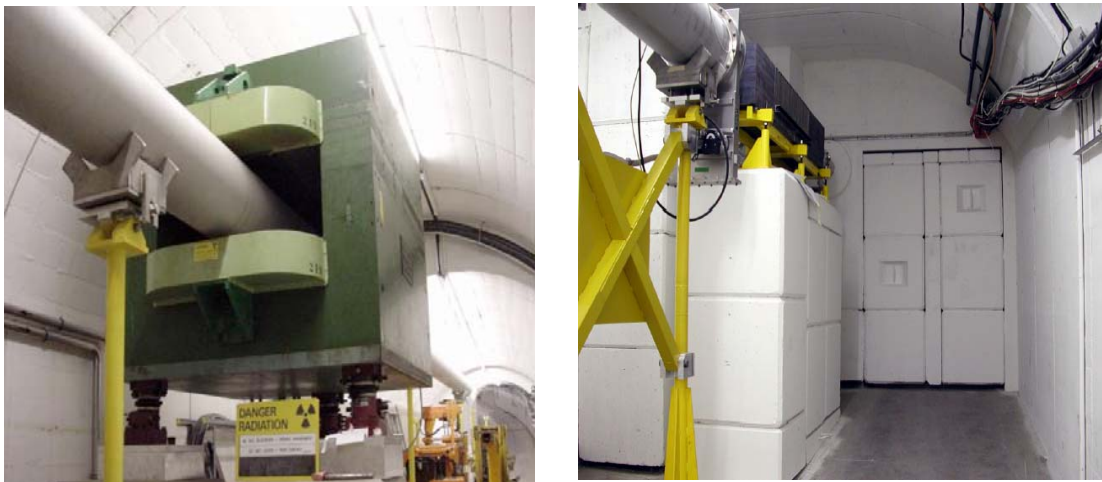
Εικόνα 3-3 Ο μαγνήτης – φίλτρο των φορτισμένων σωματιδίων (αριστερά) και ο δεύτερος κατευθυντήρας πριν τον τοίχο του χώρου μετρήσεων (δεξιά)
