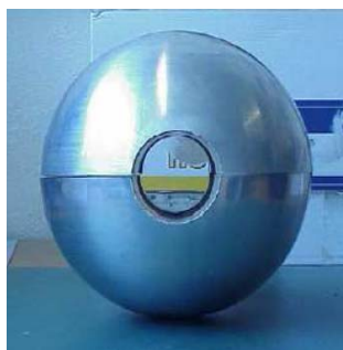
Εικόνα 3-9 Τα δύο ημισφαίρια που απαρτίζουν τον απορροφητή νετρονίων
