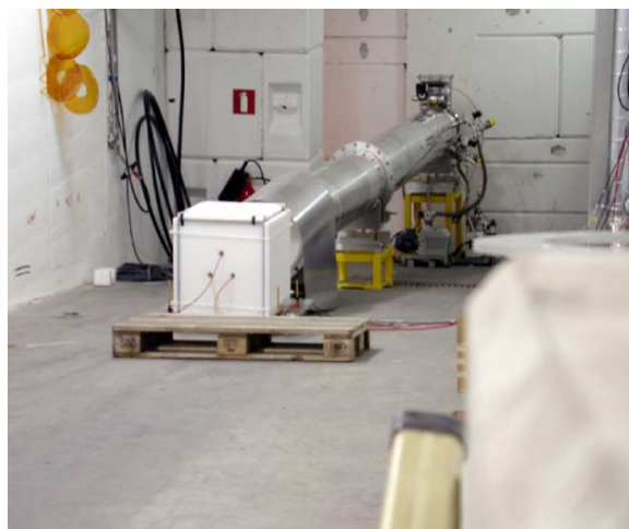
Εικόνα 3-4 Η γραμμή διαφυγής των νετρονίων και το τελικό φράγμα πολυαιθυλενίου
