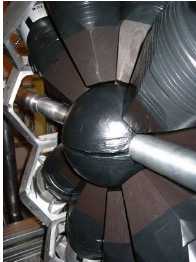
Εικόνα 3-10 Το καλορίμετρο με τον απορροφητή νετρονίων να περιβάλλει τον στόχο στο κέντρο του
