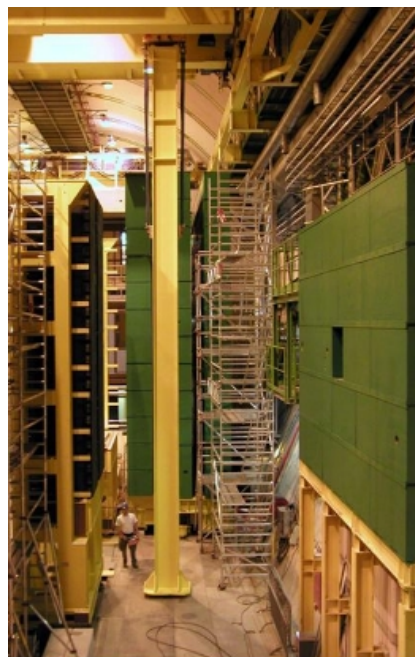
Figura 3.16: Paredes de ferro do sistema de múons usadas como filtro. Foto tirada no início da construção do experimento (não existiam as estações de câmaras entre elas).
