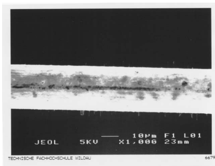
Abbildung 6.15: Bestrahlte Stelle vom Anodendraht aus Kanal 5a (betrieben in Ar/CO 2 mit 500 ppm Wasser) mit dem REM betrachtet. Neben den dunklen Flecken, die auf allen Drähten dieser Kammer zu beobachten sind, wurden auch Whiskers gefunden. Auf der Drahtoberfläche wurden Kohlen- und Sauerstoff nachgewiesen.
