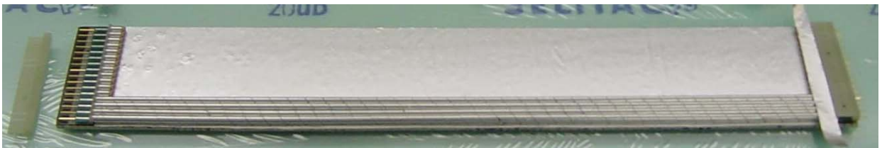
Abbildung 4.3: Das offene Testmodul während der Produktion. Die Gasverteilerbox links ist noch offen. Man erkennt die Platine, an der die Anodendrähte festgelötet werden.
