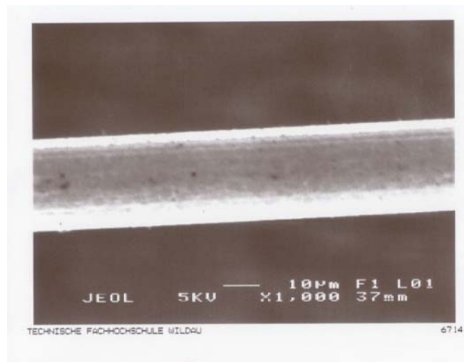
Abbildung 6.24: Ein unbestrahlter Drahtabschnitt (Kanal 1b, Position 320) betrieben in trockenem \text{Ar}/\text{CO}_2/\text{CF}_4 . Es ist kein Unterschied zu einem neuen Draht erkennbar.
