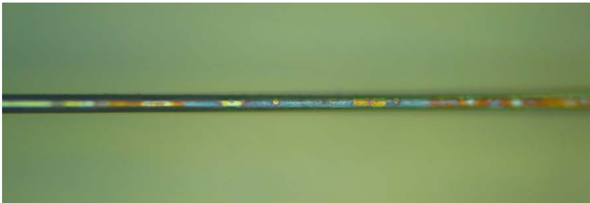
Abbildung 7.18: Bestrahlter Bereich des Anodendrahtes aus Kanal 3b. Die Verfärbungen auf der Drahtoberfläche sind charakteristisch für die bestrahlten Anodendrähte aus Doppelkammer 3.
