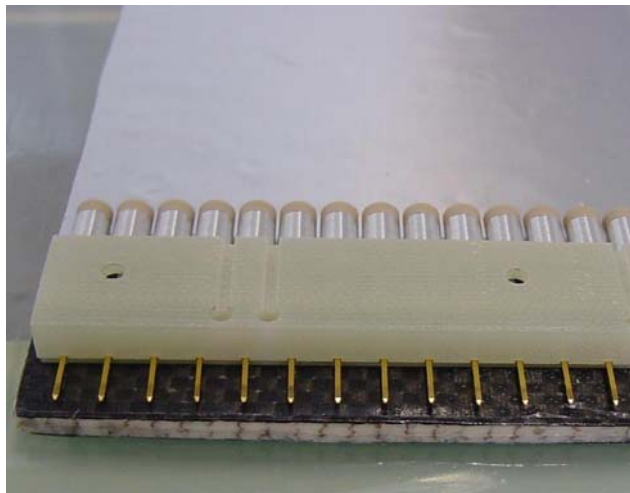
Abbildung 2.5: Die komplette Gasverteilerbox. Die Bohrungen links und rechts dienen der Zählgasversorgung der Strawtubes. Durch die Bohrungen weiter im Vordergrund wird das umhüllende Gas geleitet.
