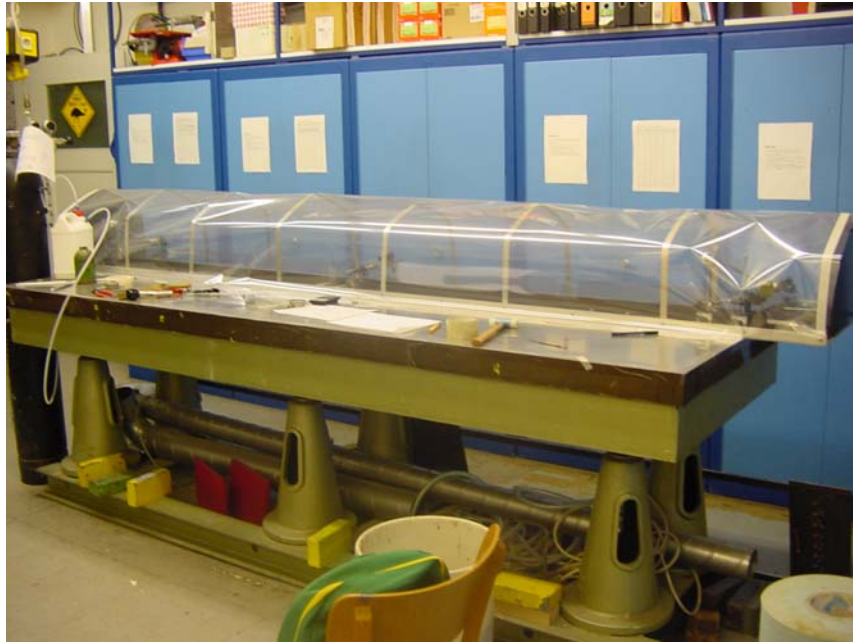
Abbildung 2.32: Die Modulbox liegt flach im Klimazelt und wird darin extremen Änderungen der Umgebungsbedingungen ausgesetzt. An den vier Ecken und in der Modulmitte werden Biegungen und Verformungen des Moduls in Abhängigkeit von Temperatur und Luftfeuchtigkeit gemessen.
