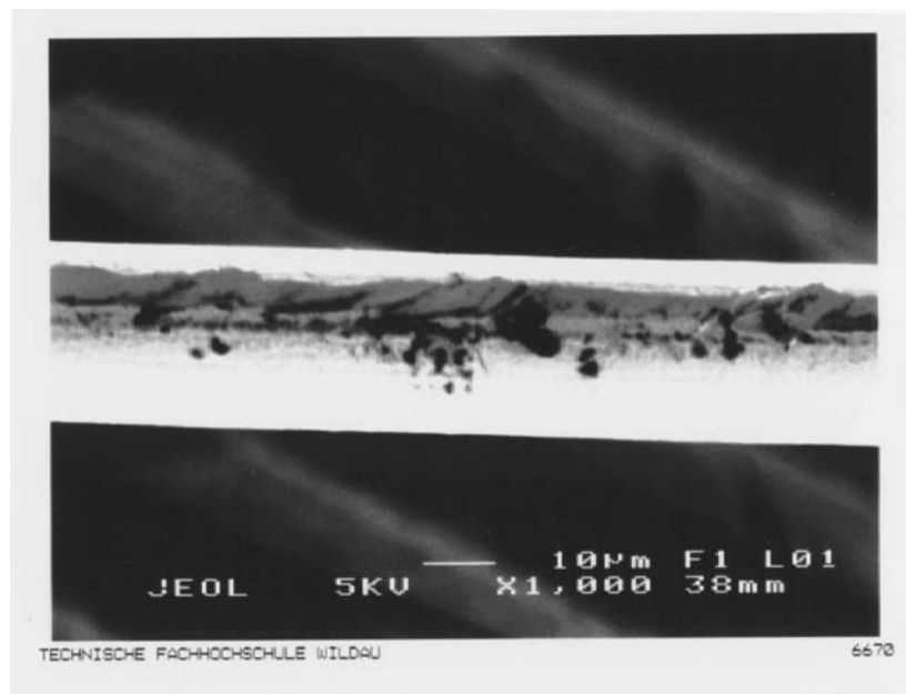
Abbildung 6.33: Bestrahlter Drahtabschnitt aus Kanal 5b, betrieben in \text{Ar}/\text{CO}_2/\text{CF}_4 mit 3500 ppm Wasser. In den schwarzen Streifen waren z.T. Vertiefungen in der Oberfläche zu erkennen. Darin wurde ein erhöhter Wolframanteil nachgewiesen.
