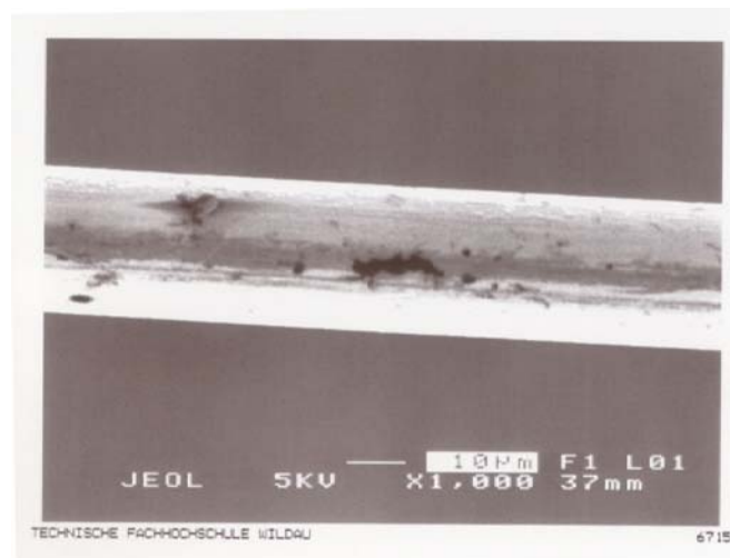
Abbildung 6.23: Bestrahlter Drahtabschnitt betrieben in trockenem Ar/CO 2 /CF 4 . Entlang der bestrahlten Region erkennt man schwarze Flecken, in denen Kohlenstoff nachgewiesen wurde.
