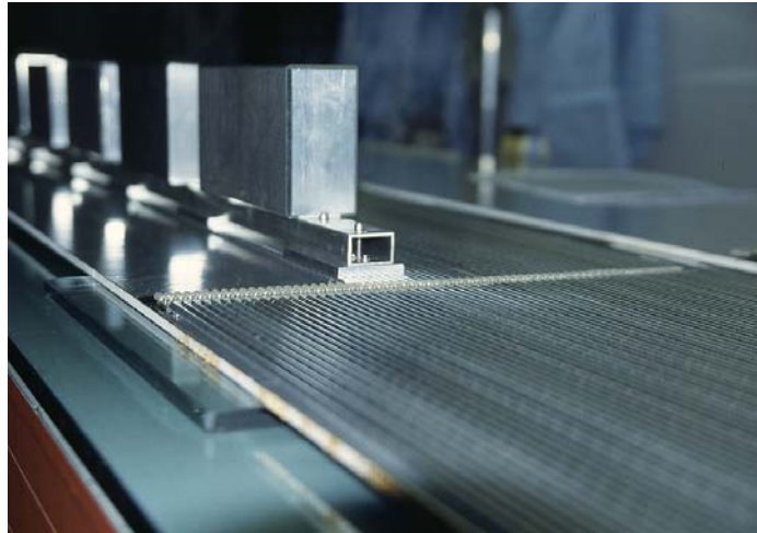
Abbildung 2.9: Aufkleben der Strawtubes auf eine Trageplatte. Immer 8 Strawtubes werden auf einmal aufgeklebt. Eine Schablonenleiste liegt mit Aluminiumblöcken beschwert auf den frisch aufgeklebten Strawtubes, damit sie positioniert bleiben bis der Kleber ausgehärtet ist.
