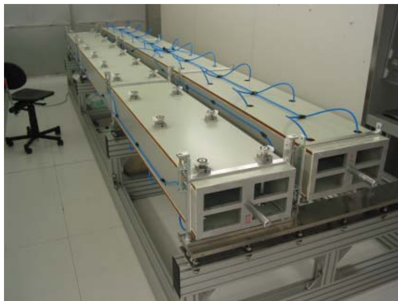
Abbildung 2.17: Zwei Tragevorrichtungen für jeweils eine Modulhälfte (aufgelegt auf festem Unterbau). Die Modulplatte wird mit zwanzig höhenverstellbaren Saugern angesaugt. Die Saugköpfe sind auf der linken Vorrichtung zu sehen. Während der gesamten Produktionsdauer bleiben die Modulplatten auf Position, auch wenn die Tragevorrichtungen umgedreht werden, wie die rechts im Bild.
