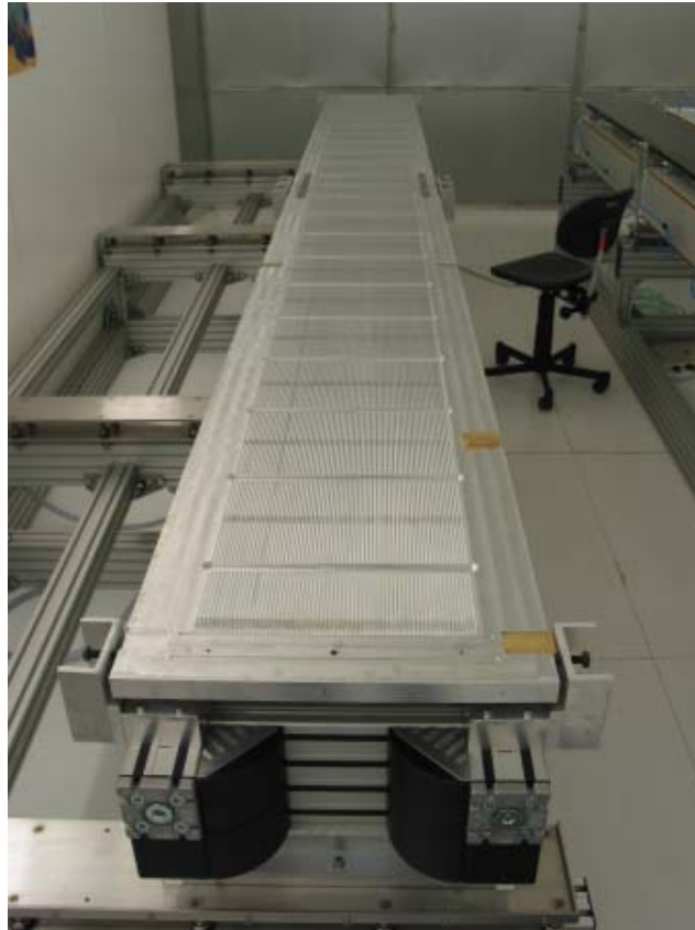
Abbildung 2.18: Das komplette Template. Es besteht aus zwei Aluminiumplatten, die fest verschraubt sind. Das Template ist exakt ausgerichtet auf einem stabilen Unterbau befestigt. Es wird während der gesamten Kammerproduktion nicht mehr bewegt. In die langen Furchen werden die Strawtubes eingelegt. In regelmäßigen Abständen werden die Strawtubes durch Löcher angesaugt, damit sie sich nicht aus den Furchen biegen. Mit Hilfe von Passbohrungen werden die HV-Platinen und die Modulplatten exakt positioniert.
