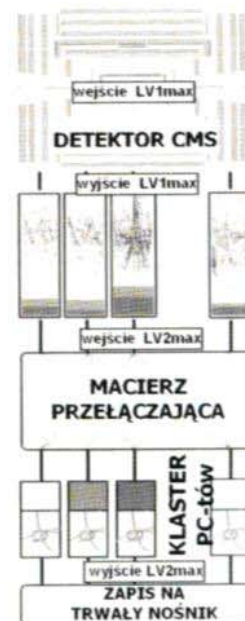
Rys. 9. Stopniowa selekcja przypadków w eksperymencie CMS Fig. 9. Multistage selection of events in the CMS experiment
